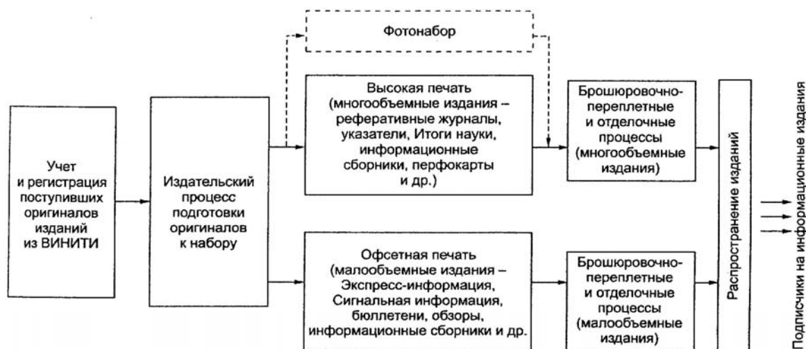
Рис. 14.4. Блок-схема основных технологических процессов подготовки и выпуска информационных изданий ВИНТИ в его Производственно-издательском комбинате.
