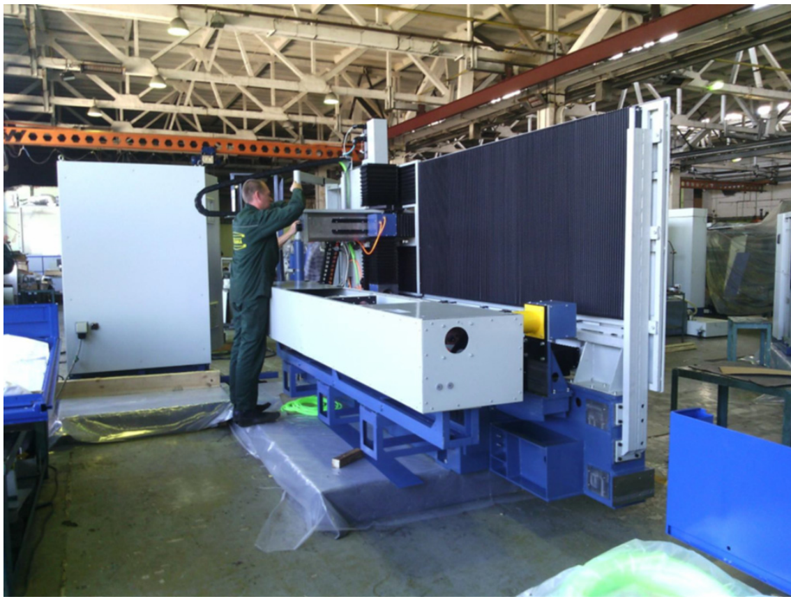
Сборка Лазерного комплекса мощностью 5 кВт
