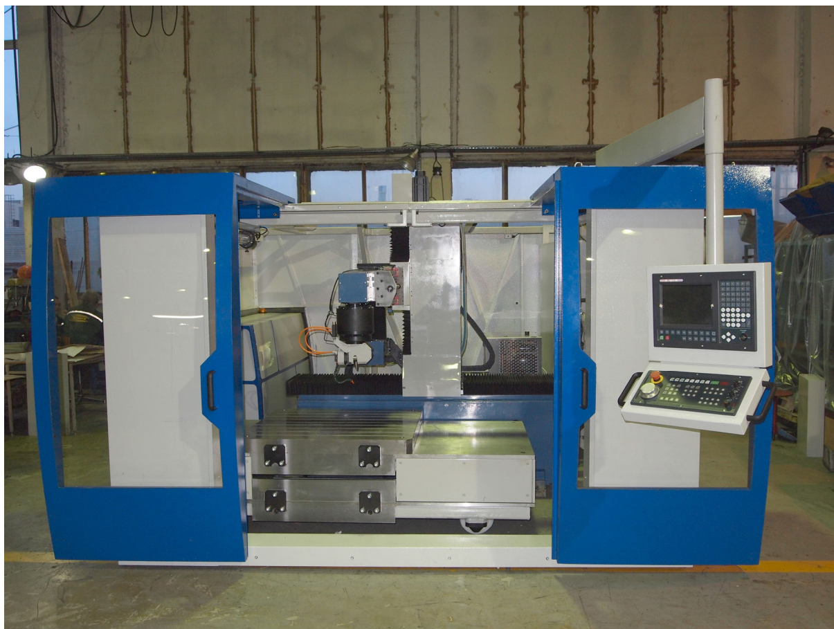
Автоматизированный Лазерный комплекс мощностью 3 кВт
